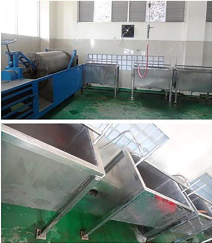
Gambar 3.2 Contoh Bak Tempat Pencucian
